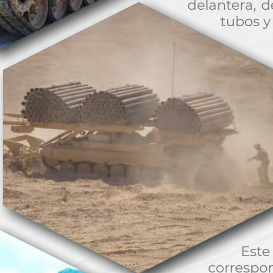
El diseño y fabricación de las fajinas de tubos constituyó una tarea de gran relevancia, alcanzando un excelente resultado con plena disponibilidad de producción local. Este vehículo blindado, inspeccionado y aprobado por IDIC<sup>1</sup>, consta de una cúpula blindada para cubrir el compartimiento de la tripulación, una plataforma basculante trasera y una delantera, destinadas a transportar tres fajinas pesadas de tubos y lanzarlas dentro de zanjas profundas.
