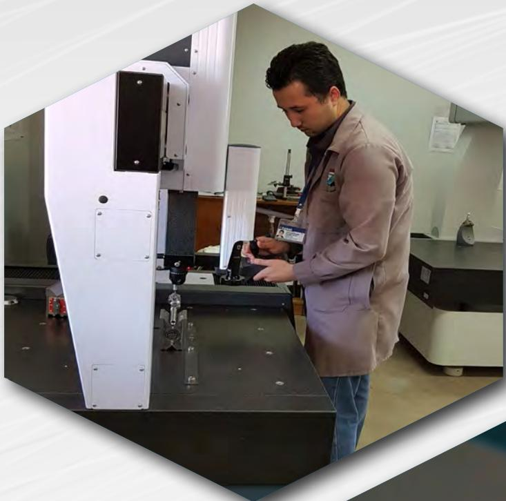
El área metrológica efectúa todos los controles dimensionales de las piezas fabricadas, con instrumentos tradicionales como pie de metro, micrómetros, reloj comparador, entre otros elementos de medición.
